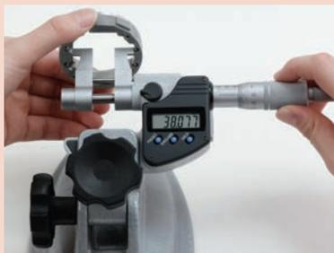
Funciones\*: configuración en origen, puesta a cero en cualquier punto y detención de lectura
