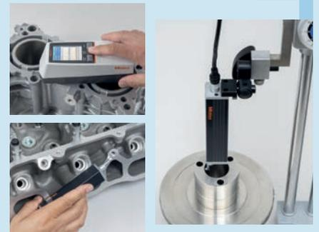
Dispositivo para medir la rugosidad en el asiento de la válvula en las cabezas
